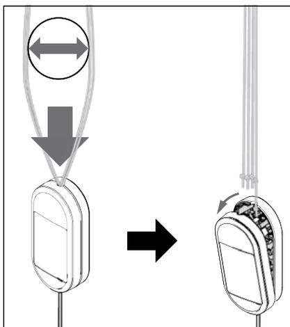
Alle schnurbedienten Anlagen werden mit einer Sicherheitschnurquaste ausgeliefert. Diese öffnet sich, sobald die Schnüre 60 mm auseinandergezogen und gleichzeitig mit 6 kg belastet werden.
