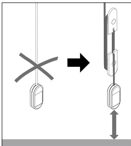
Bei schnurbedienten Anlagen müssen grundsätzlich Schnurwickler montiert werden.
