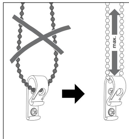
Bei kettenbedienten Anlagen müssen grundsätzlich Kettenhalter montiert werden.
