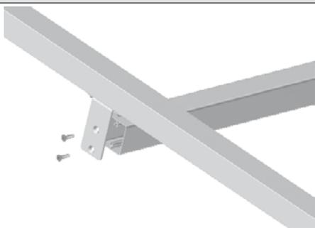
ab 351 cm Ausfall inkludiert; Tuchunterstützung 75 x 63 mm; stranggepresst; inkl. Träger mit 95 mm Abstand (bis 400 cm Breite) oder 130 mm Abstand (ab 401 cm Breite); Oberfläche pulverbeschichtet
