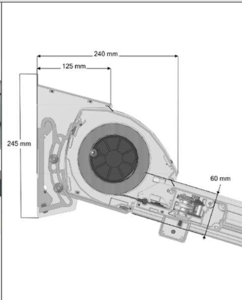
Antriebseinheit mit Wandkonsole, Abdeckungen und Führungsschiene
