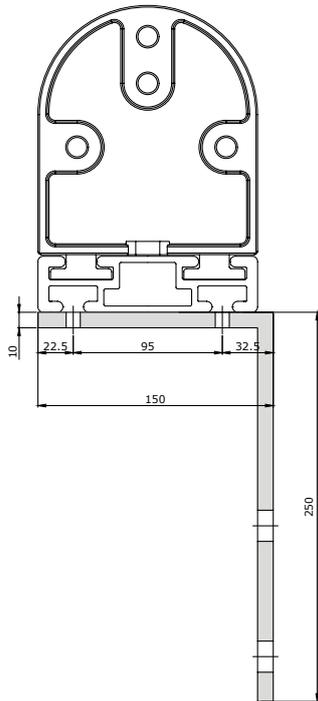
Sonderkonsole für die Montage auf Dachsparren in Kombination mit der Deckenkonsole. Verwendung je Deckensole eine Dachsparrenkonsole notwendig.
