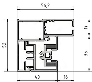
Zweiteilige Führungsschienen mit Kunststoffkeder zur Führung eines Textilen Screen-Behangs mit ZIP und zusätzlicher Führungskammer für die Insektenschutzgaze des ZRCI-H oder ZRCI-H-NF.
