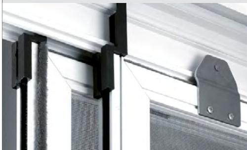
Aluminium; stranggepresst; Oberfläche pulverbeschichtet; Rollen aus hoch gleitfähigem verschleißfestem Kunststoff; Rollenträger und Achse aus nichtrostendem Stahl, blank; inkl. Aushängesicherung
