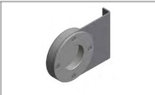
Design Muschelgriff aus Edelstahl; Durchmesser 54 mm; Höhe 13 mm; Oberfläche gebürstet; Bespannung Pollenschutzgaze, Petscreen, Aluminium, Edelstahlgewebe und Soltis bei UGL nicht möglich!
