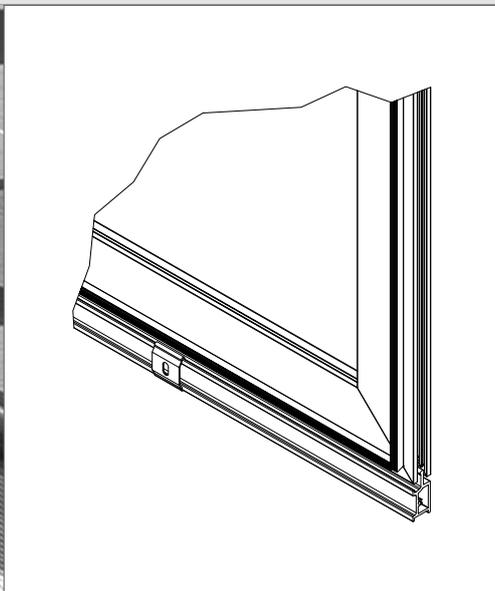
Aluminium; stranggepresst; Oberfläche pulverbeschichtet; inkl. Aushängesicherung; inkl. Soft-Stop; Rollen aus hoch gleitfähigem verschleißfestem Kunststoff; Rollenträger und Achse aus nichtrostendem Stahl, blank; Befestigung nicht sichtbar mit Montage-Clips; optional Bodenprofil Höhe 12 mm zum verkleben; optional Fensterprofil mit Montage-Clip verschraubt
