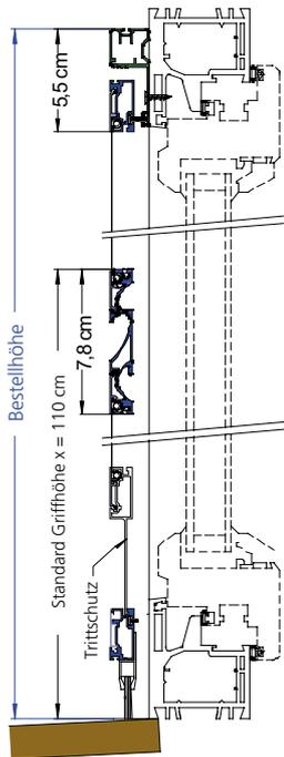
VERTIKALSCHNITT KATZENKLAPPE ISS-KAKLA
