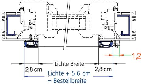
HORIZONTALSCHNITT IN VERBINDUNG MIT ROLLADEN DFSE
