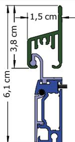
Aluminium; stranggepresst; 28 x 12 mm; pulverbeschichtet; auf Gehrung geschnitten; inkl. Aluminium Blende als Abdeckung für unsichtbaren Keder
