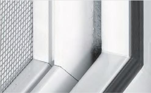
qualitativ hochwertige Dichtbürste; grau; Standard Höhe 3 mm (Typ1); optional Höhe 7 mm (Typ2), 16 mm (Typ3) oder 25 mm (Typ4); umlaufend zum Fenster; optional für Nische
