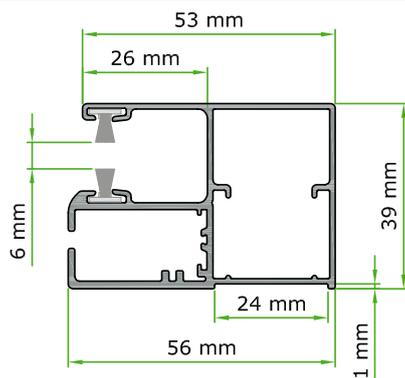
Führung in der Rollladen-Kombischiene DSFI (53 x 56 x 39 mm); Aluminium; stranggepresst; Oberfläche pulverbeschichtet; inkl. Einlauftrichter (in FS eingesteckt, einfach austauschbar)
