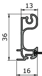
Aluminium; stranggepresst; C-förmig; 16 x 36 mm; pulverbeschichtet; mit integrierter Dichtbürste; mit Griff Ring; optional mit Schnur und Quaste
