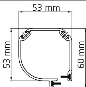
einteilig; 2 mm starkes Aluminium; stranggepresst; Oberfläche pulverbeschichtet; Behangeinlauf außen und innen mit Bürstendichtung; Kassette groß 53 x 53 mm
