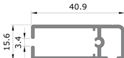
Aluminium; stranggepresst; 16 x 41 mm; Oberfläche pulverbeschichtet
