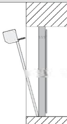
Das Element wie in Abb. in die Laibung vor den Fensterrahmen setzen (zweite Person) und die Feder in die Bohrung im Fensterrahmen einführen. Die Schnur anschließend durch die Feder nach innen führen bzw. den Gurt durch die Bohrung stecken.
