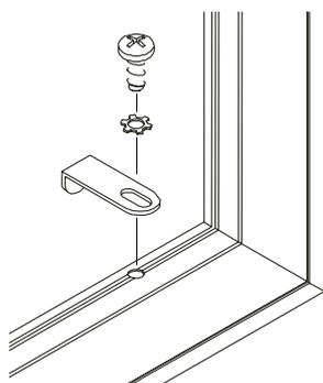
Einhängehaken an das untere waagrechte Rahmenprofil schrauben und auf Hakenlänge „0- 8“ justieren.
