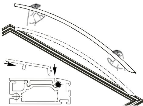
Blende leicht überbiegen und mit den Ecken voraus in hintere Nut (mit eingelegter Rundschnur) wie im Querschnitt dargestellt einstecken.
