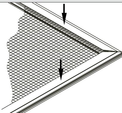
Die Blenden mittels festem Druck einklipsen.
