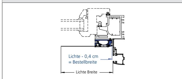
HORIZONTALSCHNITT DFSE FÜHRUNGSSCHIENE
