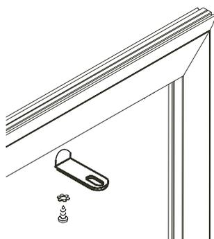
Gefederte Einhängehaken an das obere waagrechte Rahmenprofil schrauben. Die Sicherung muss dabei weiter zur Ecke hin liegen um nach dem Einhängen des Rahmens die Sicherungsfunktion übernehmen zu können.
