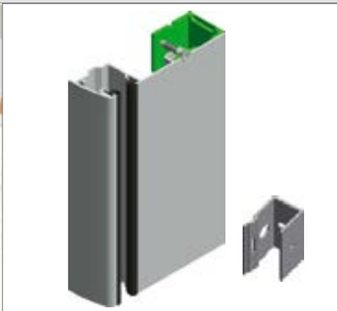
Patentierter VALETTA Softführungsschiene mit geräuschkämpfender Gummieinlage für Raffstore für einen absolut leisen Lauf des Behanges oder mit Soft-Fin Bürste für einen weichen Lauf bei der Rollladenkomplettierung. Befestigung mit Montage Clip am Fensterstock ohne sichtbare Schrauben; Aufputz oder Einputz (mit Softschieneinputzprofil). Kombinierbar mit Insektenschutzführungsschiene.
