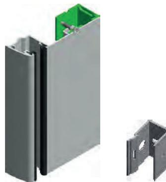
Patentierter VALETTA Softführungsschiene mit geräuschkämpfender Gummieinlage für einen absolut leisen Lauf des Behanges. Als Einzel- oder Doppelführungsschiene. Befestigung mit Montage Clip am Fensterstock ohne sichtbare Schrauben; Aufputz oder Einputz (mit Softschieneneinputzprofil). Kombinierbar mit Insektenschutzführungsschiene.
