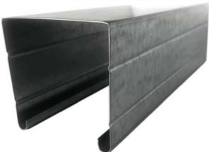
0,6 mm starkes Stahlprofil; rollgeformt; verzinkt; U-förmig; 58 x 56 mm; nach unten offen; über 180 cm Breite mit Alu-Hutprofil verstärkte Oberschiene
