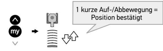
**⚠** Vor der Einstellung der horizontalen Lamellenposition muss der maximale Wendebereich eingestellt werden.
