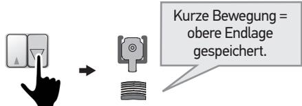
1 Wenn die obere Endlage während eines Zyklus automatisch geändert wurde, ist die Funktion der automatischen Nachregelung aktiviert.
