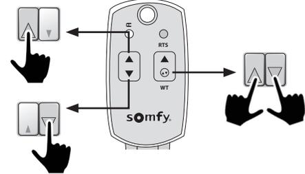
Die Bedieneinheit vom Typ „Drucktaster ohne Verriegelung“ eignet sich nur für die Installation.
