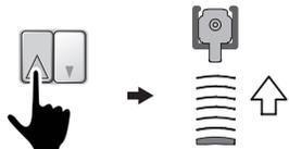
1 Wird die Außenjalousie bis zum Kontakt mit dem Schaltfühler aufgefahren, wird die Position der oberen Endlage ca. 5 mm unterhalb der Schaltfühlerposition gespeichert.
