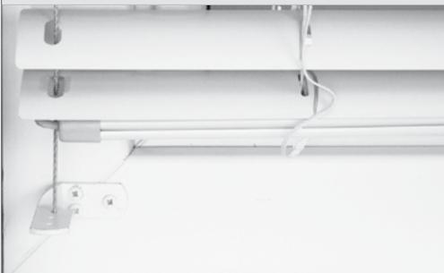
Seilführung; Kunststoffummanteltes Stahlseil 2,2 mm; optional in schwarz; Aluminium Abspannwinkel; Standardfarbe weiss; optional in braun, schwarz oder Aluminium natur (Aufpreis); optional Geräuschdämmungsöse (Aufpreis); Seiltopf Bodenbefestigung (Aufpreis)
