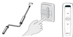
Kurbelbedienung: mit integrierter Getriebe-Freilauf-Technik (GFT) abnehmbarer Bedienungskurbel in verschiedenen Standardlängen (100, 120, 140, 160, 180, 200 cm).
