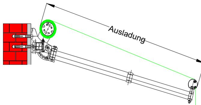
AUSLADUNG = Hinterkante Tuchwelle bis Vorderkante Fallschiene bei komplett geöffneten Gelenkarmen.
