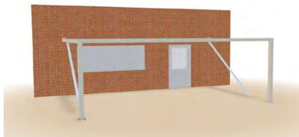
Befestigen Sie die Führungsschienen durch die gebohrten Löcher mit M6x14 Zylinderkopfschrauben. Legen Sie die Führungsschienen auf dem Boden ab.
