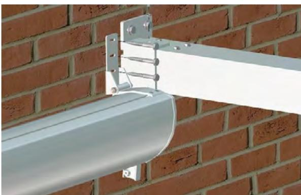
Kippen Sie die Kassette und zeichnen Sie die Löcher an. Bohren Sie Löcher für die Befestigung der Konsole. Lassen Sie sich dabei gegebenenfalls von Ihrem Befestigungsmittellieferanten beraten. Montieren Sie die Konsole an die Wand.
