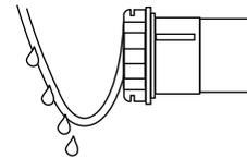
Verlegen Sie die Anschlussleitung des Antriebes in einer Schlaufe nach unten, damit kein Wasser in den Antrieb eindringen kann.
