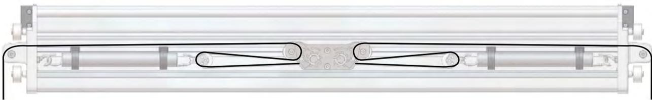
Öffnen Sie das Ausfallprofil indem Sie die Abdeckung lösen. Führen Sie die Kordel wie abgebildet durch das Fallprofil und befestigen Sie diese am Kordelspanner.
