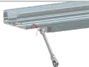
Befestigen Sie die Sechskantmutterverbindung, um das Fallprofil zu spannen.
