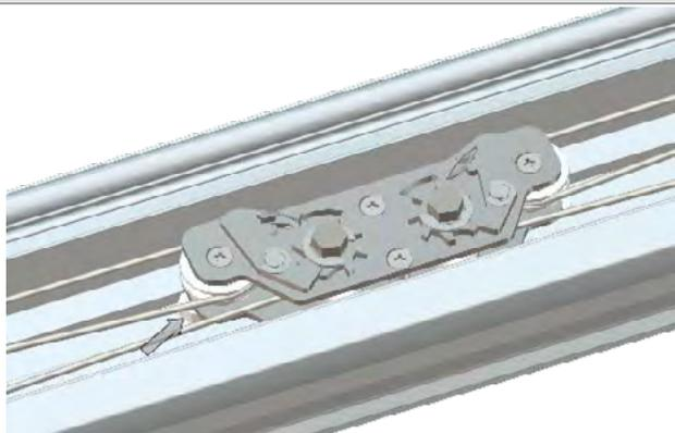
Bringen Sie den Kordelspanner im Fallprofil an und befestigen Sie diesen, indem Sie mit einem Schraubenzieher die Kunststoff Führungsblöcke des Kordelspanners drehen. Spannen Sie das System, drehen Sie dazu den Kordelspanner in die angegebene Richtung.
