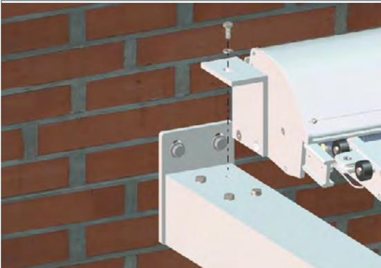
Bringen Sie die Kassette auf den Trägern an und befestigen Sie diese auf jeder Seite mit dem vierten Schrauben. Kippen Sie die Kassette und schrauben Sie die Bügel mittels Blechschrauben M6x12 auf das Kassettenprofil.
