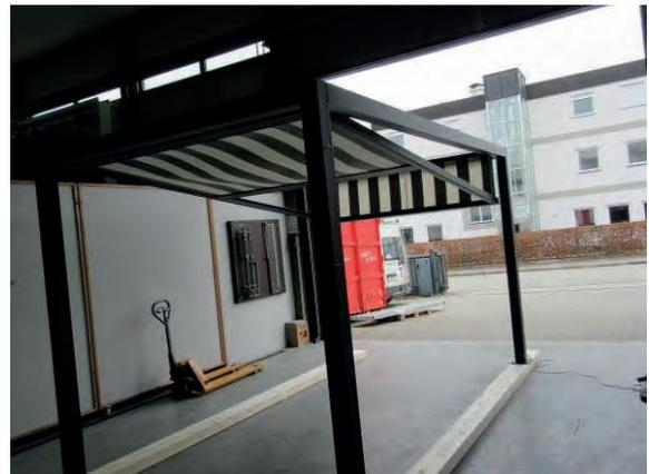
**Bild 9** Probekörperansicht, Markise auf maximale Stellung abgesenkt
