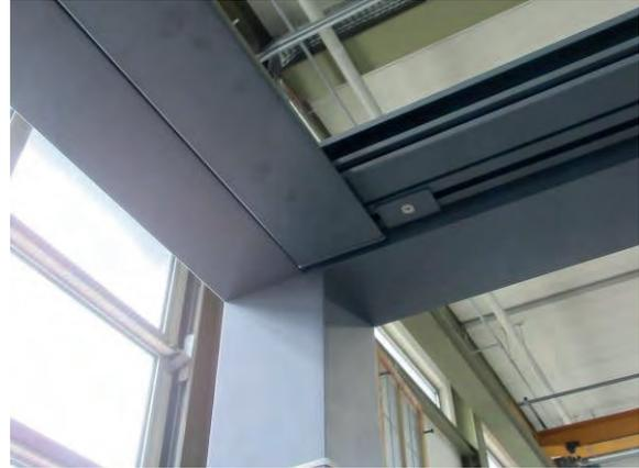
**Bild 19** Eckausbildung des Probekörpers auf der Vorderseite, von unten gesehen
