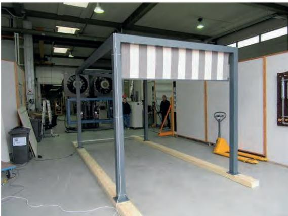
**Bild 8** Probekörperansicht, Markise auf maximale Stellung abgesenkt
