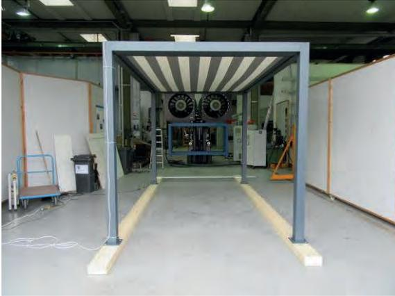
**Bild 6** Ansicht des Probekörpers mit Gebläsepositionierung
