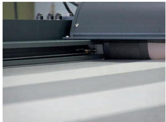
**Bild 15** Führungsschiene
