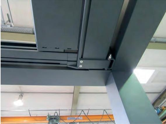
**Bild 18** Eckausbildung des Probekörpers auf der Rückseite, von unten gesehen
