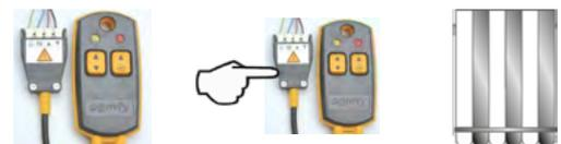
2. AUF-/AB-Taste am Einstellkabel solange drücken, bis der Antrieb einmal mit einer kurzen Auf-/Ab-Bewegung bestätigt.
