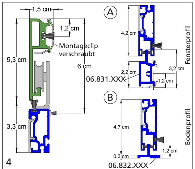
Detail Aufhängung. Beachten Sie vor dem Einhängen, dass die Laufschiene und Führungsschiene frei von Schmutz sind.
