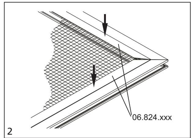
Die Blenden 06.824.xxx mittels festem Druck einclippen.
