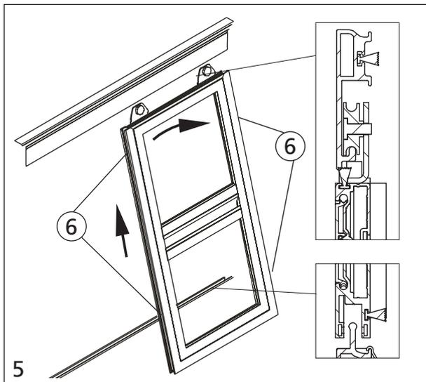
Zum einhängen des Rahmens diesen mit den Laufrollen nach oben anheben und die Laufrollen von hinten die Laufrollenführung einhängen. Darauf achten, dass das untere Querprofil das Führungsprofil umschließt.
