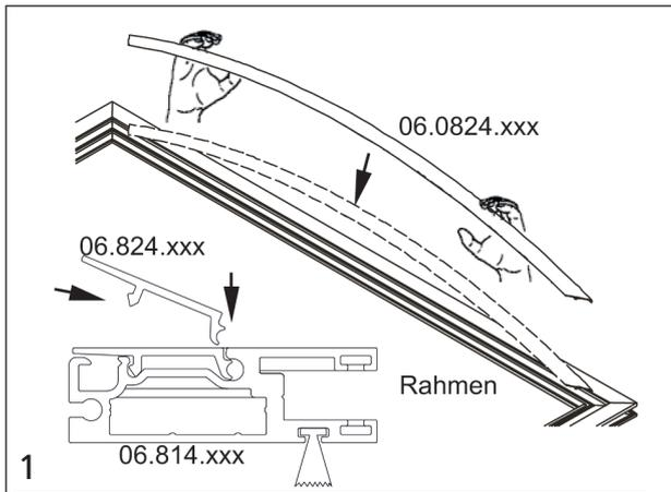
Blende 06.824.xxx leicht überbiegen und mit den Ecken voraus in hintere Nut (mit eingelegter Rundschnur) wie im Querschnitt dargestellt einstecken.
