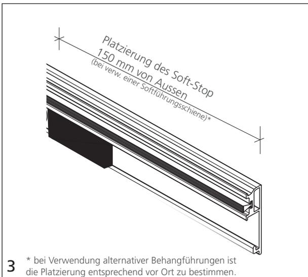
Montage des Soft-Stop links und rechts in der Führungsschiene der Schiebetür mittels Selbstklebefolie. Bei einem Einbau in Kombination mit einer VALETTA Softführungsschiene Abstand zur Aussenkante 150 mm (bei alternativer Behangführung ist der Stopper entsprechend zu platzieren).
