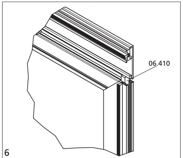
Montage der Aushängesicherung (06.410) am oberen Eck des Rahmenprofils um ein unbeabsichtigtes Aushängen der Schiebetür zu verhindern.
