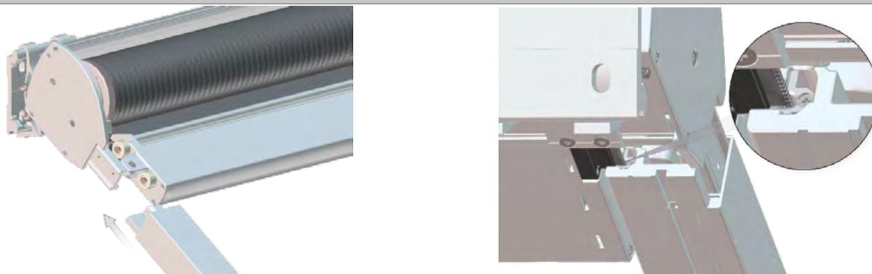
Stecken Sie die Rollen des Führungsblocks in die Führungsschiene und schieben Sie die Führungsschiene auf die Konsole. Achten Sie darauf, dass die Kordel in der Führungsschiene frei beweglich bleibt.
