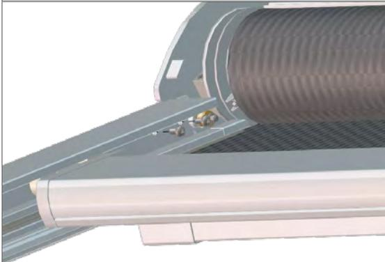
Befestigen Sie die Führungsschiene durch die gebohrten Löcher mit den Zylinderkopfschrauben M6x14.
