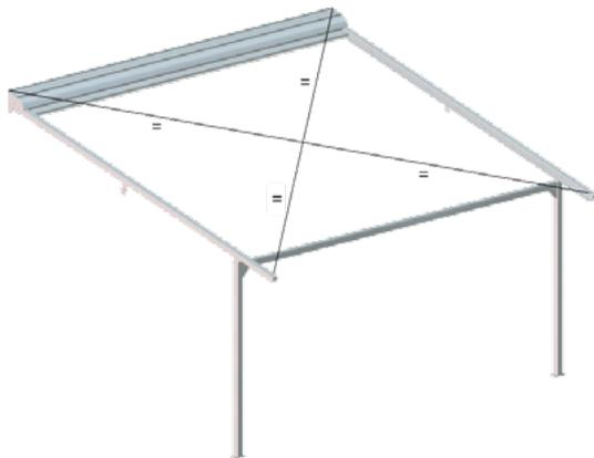
Messen Sie die Diagonale des Systems um Diametral zu überprüfen. Setzen Sie die Steher und befestigen Sie diese auf den Boden oder Betonsockel.
