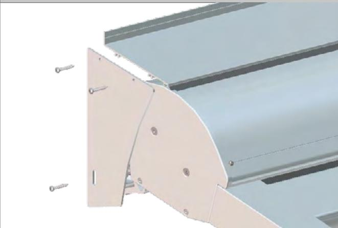
Befestigen Sie die Seitenabdeckung am Wandprofil und an der Montagekonsole.
