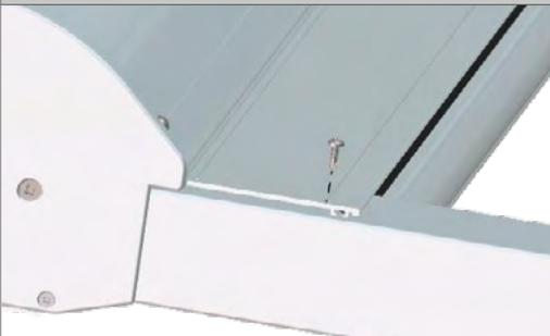
Haken Sie die Abdeckung für das Ausfallprofil mit Bürste in das Dachprofil und schrauben Sie es seitlich mit den Bohrschrauben 4,2 x 25 mm fest und stecken Sie die Abdeckkappen auf.
