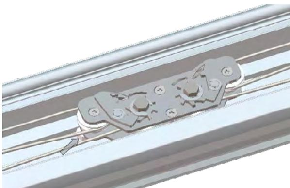
Bringen Sie den Kordelspanner im Fallprofil an und befestigen Sie diesen, indem Sie mit einem Schraubenzieher die Kunststoff Führungsböcke des Kordelspanners drehen. Spannen Sie das System, drehen Sie dazu den Kordelspanner in die angegebene Richtung.
