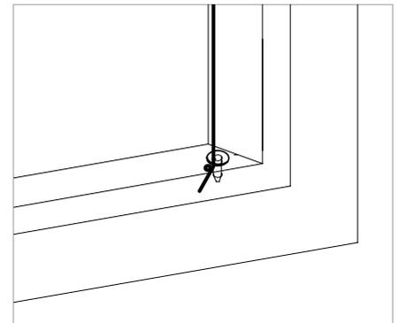
Bei Metall- und Kunststofffenster 3,2 mm bohren. Seil mit Knopf, der ca.1 cm tiefer als die Lichthöhe sein soll, in die Bohrung stecken, Seilnippel nachstecken, festhalten und am Seil nach oben ziehen bis Knopf am Nippel innen ansteht.
