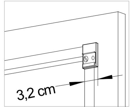
Distanzunterlagen maximal 3,2 cm von der gemessenen Glaslichte bis Außenkante Distanzplatte, bei Standard Überstand der Soft-Abdeckung von 3,5 cm montieren.
