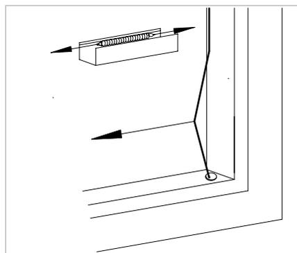
Durch seitliches Ziehen an den beiden Kunststoffseilen wird die Feder von der Vorspannungsleiste ausgehängt, dadurch ergibt sich eine optimale Seilspannung.
