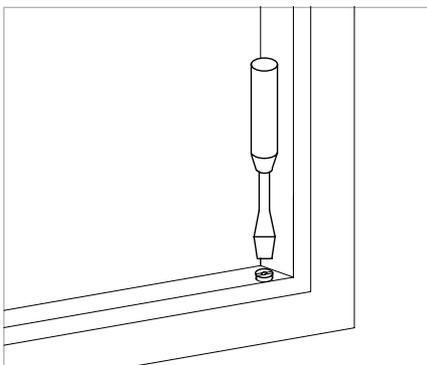
Bei Holzfenster 5,5 mm bohren, Metall-Einschraubnippel einsetzen, sonst wie im vorigen Bild beschrieben weiter montieren.
