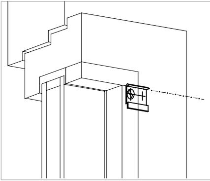
Träger mit Innenkante der oberen Clipsnase, auf Innenkante der Glasleistenflucht oder Fensterrahmen montieren.
