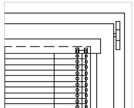
Durch Ziehen an der Bedienungskette wird Heben und Senken, sowie durch wechselseitiges Ziehen an der Bedienungskette, das Wenden der Lamellen erreicht.
