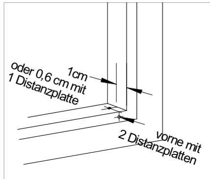
Seilabstände in der Breite aufteilen. In der Tiefe 1 cm Abstand von Innenkante Fensterrahmen bohren. Achtung bei Verwendung 1 Distanz- Unterlage Bohrung im Abstand von 0,6 cm und bei 2 Distanzunterlagen vorne anbringen.
