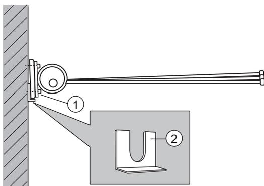
Mitgelieferter Unterlegkeil zwischen Wand- und Montageplatte schieben.
