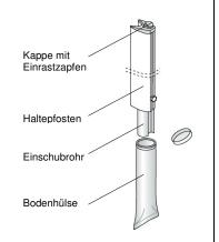
Bodenhülse in Beton im Erdreich verankern, Einschubrohr in Bodenhülse schieben und Haltepfosten aufstecken.
