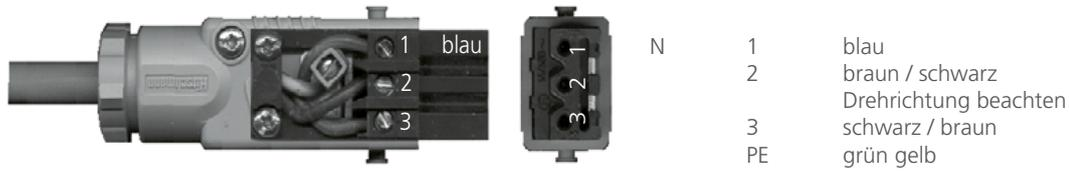
ANSCHLUSSPLAN - FUNKMOTORE FMM4 | FMM5 - ZULEITUNG - HIRSCHMANNKUPPLUNG
